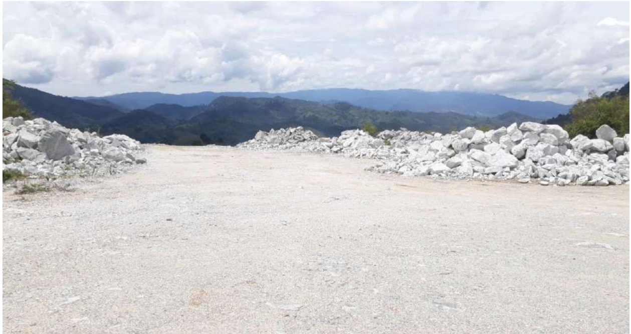
รูปที่ ๖ พื้นลานกองแร่เปลือกดินและเศษหินบดอัดแน่น
